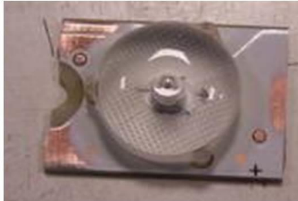
Ausgesägte funktionierende LED mitsamt Streulinse
