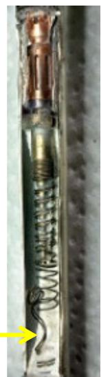
Links eine Messung an einem Heizkörper mit dem Wert 26,86 Ω, rechts der Wert eines Heizkörper mit defekter Schmelzsicherung und durchgebrannten Heizdraht.
