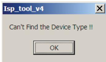
Bei dieser Fehlermeldung wird der eingebaute Speicher nicht erkannt: richtiger Sitz der beiden Jumper kontrollieren (4/11) und VGA-Kabel (4 mit 4 und 11 mit 11, nicht auf Masse und nicht miteinander verbunden)
