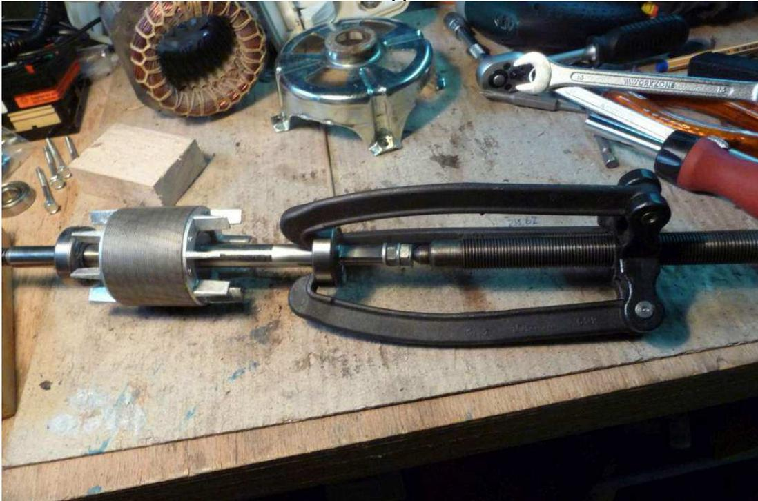
Für das Aufpressen des neuen Lagers braucht man eine Vorrichtung. Hier einfach mit einer großen Schraubzwinde, dem alten Kugellager als Druckstück und einem genau passenden Rohr mit 12,5 mm I.D. realisiert. Der Rohraußendurchmesser entspricht dem Innenring.
