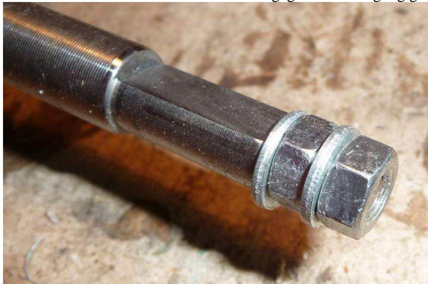
Zum Abziehen braucht man unbedingt einen geeigneten Abzieher. Mit Unterlegen eines Maulschlüssels o.ä. geht das nicht. Das Lager ist wirklich fest aufgepresst. Der Abzieher muss exakt zentrisch sitzen, sonst klappt das nicht.
