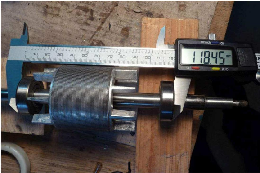
Das Lager ist mit Festsitz aufgespresst und muss vorm abziehen genau ausgemessen werden. Die Position des Lagers wird nicht durch einen Seegerring oder ähnliches fixiert, wie es bei jüngeren Modellen der Fall ist. Daher den Messwert genau aufschreiben.
